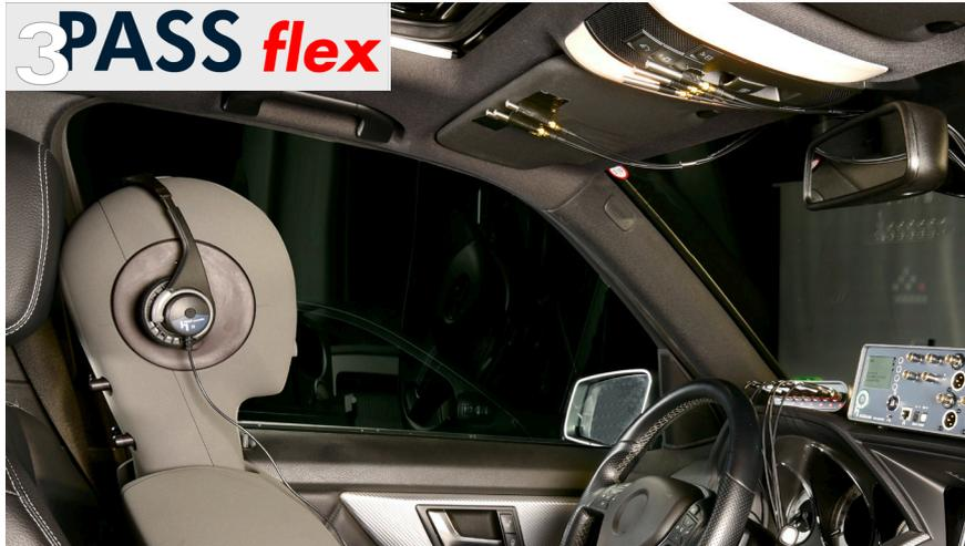
车内定制麦克风配置3PASS flex应用示例
